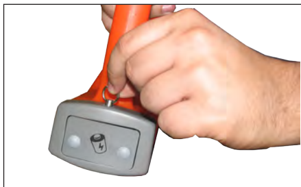
а) Выдвинуть фиксатор и освободить батарейный отсек
